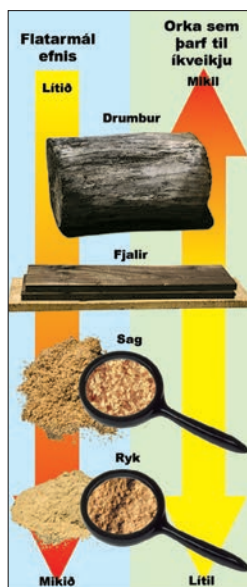
Mynd 2.5 Flatarmál. Því duftkenndara efni (meira flatarmál), því minni orku þarf til þess að koma af stað eldi.
